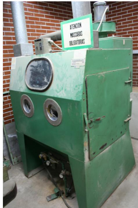
Fig. 1.14. El Sand Blast es un proceso complementario dentro del desarrollo de producción de las piezas.
