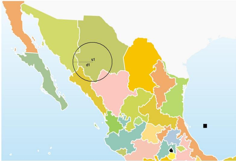
Figura 3.10: Medición de la distancia del epicentro con una sólo estación
