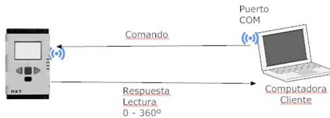
Figura 4.3: Comunicación Bluetooth entre Cliente y Servidor NXT
