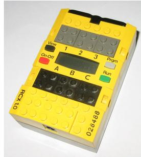
Figura 3.6: La primera generación del Brick Lego Programmable [Wik09]
