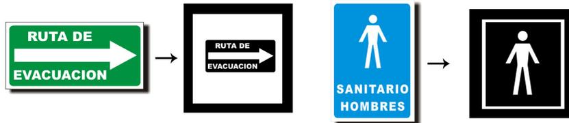
Figura 3.4: “Conversión de señalamientos cotidianamente utilizados a marcas válidas de ARToolKit”
