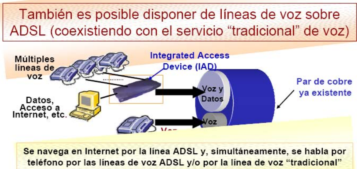
Figura VI.3.2.- Diagrama de voz y datos por un mismo medio
