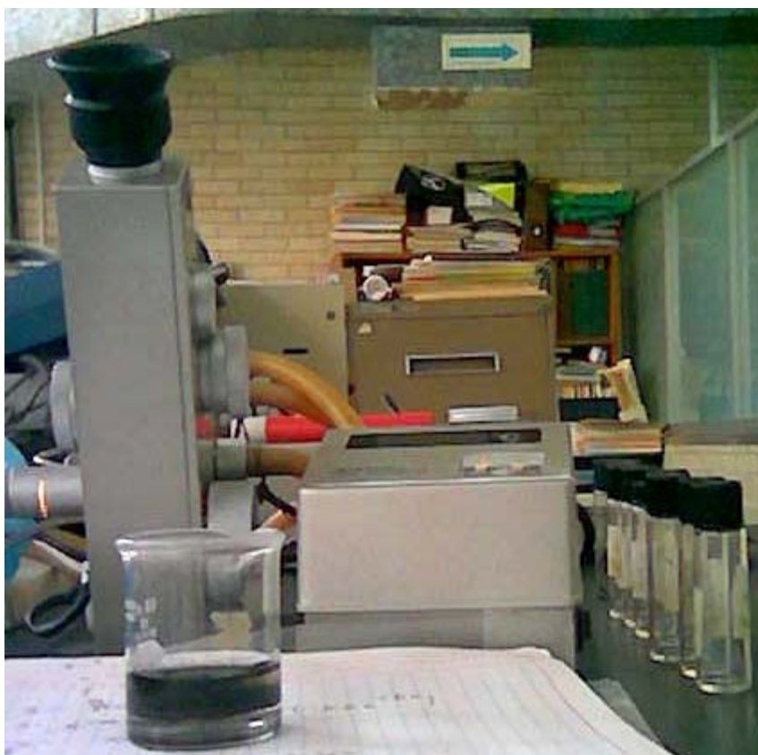
Figura 1- 5: Refractómetro utilizado en la determinación de índices de refracción de muestras, con indicador de temperatura electrónico.
