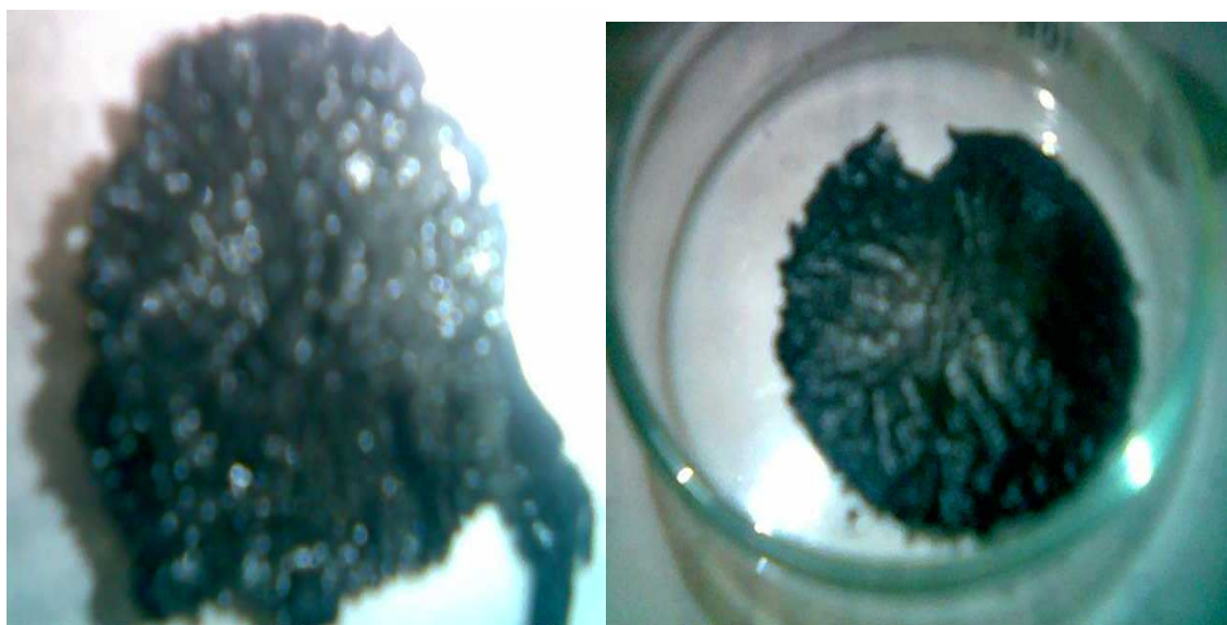
Figura AI- 4: Películas de polipirrol resultantes con relaciones monómero oxidante igual a 2 y 1 respectivamente. Presentación de partículas de plata en la matriz polimérica.
