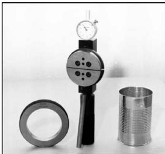
Plug diameter gauge, dispositivo desarrollado para determinar el diámetro interior del envase.
