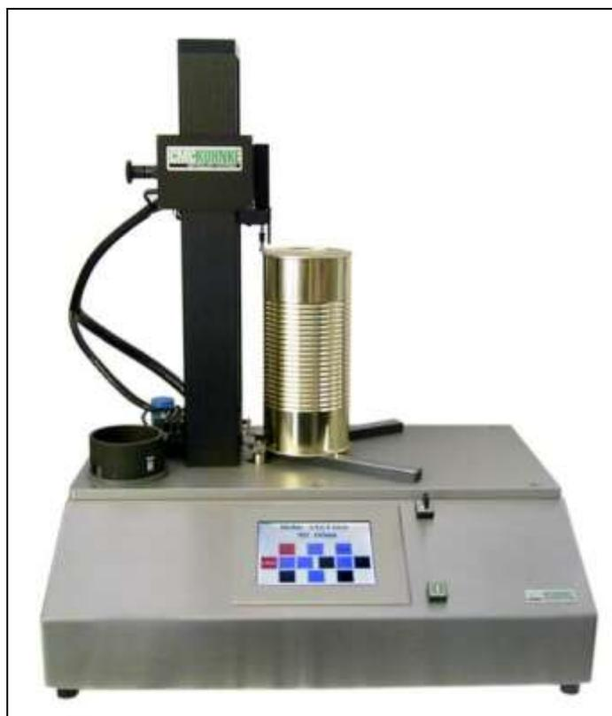
BHF-2000 dispositivo para determinar la altura de envases, dimensiones de pestaña y profundidad de cordones
