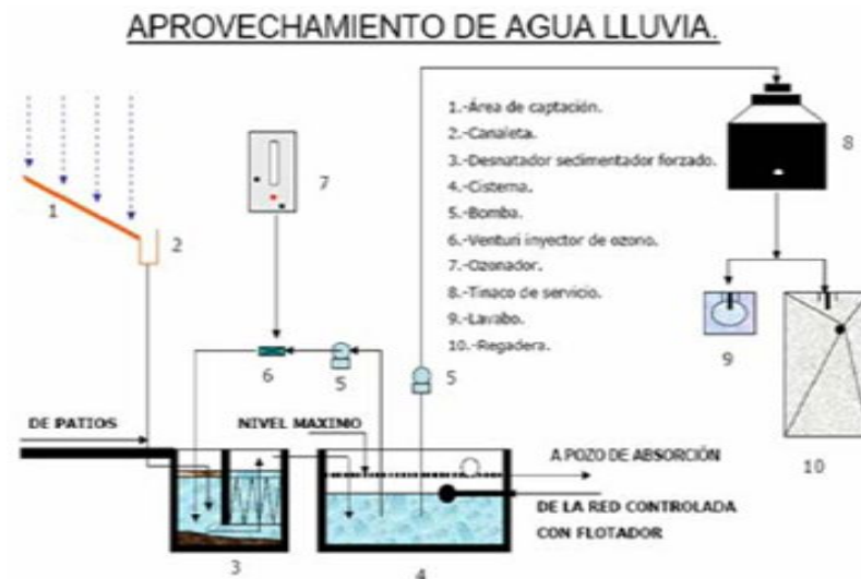
Imagen 6.1. Captación y Potabilización de Agua Pluvial.
