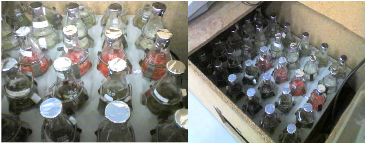
Figura 8 En la foto se puede observar la fitorremediación de vegetales en secciones, los matraz Erlenmeyer deben estar cubiertos y bien etiquetados (vegetal, tipo de contaminante y concentración). El mismo procedimiento se realiza para la fitorremediación de vegetal en extracto y en polvos acetónicos.
