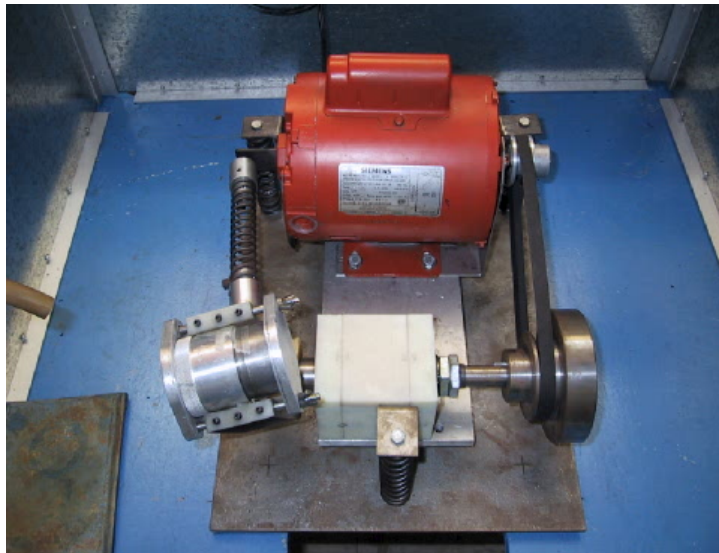
Figura 2.2 Sistema de aleado mecánico construido en el ININ.
