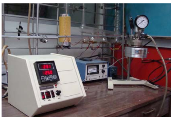
Figura 2.6 Micro-reactor Parr Instrument Company modelo 4842, utilizado en el proceso de hidrogenación
