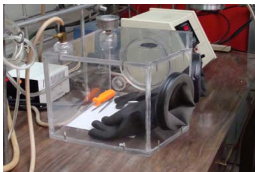
Figura 2.1 Caja de Guantes hecha de lucita, construida en el ININ.
