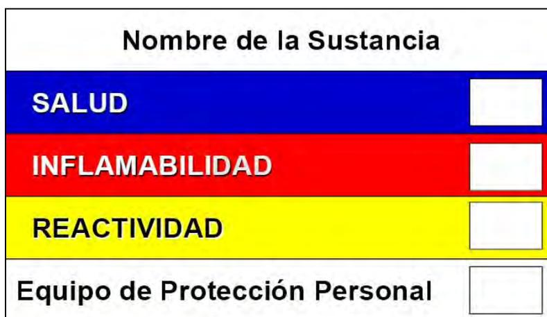
**Figura 1. Rectángulo de Identificación de materiales peligrosos**
