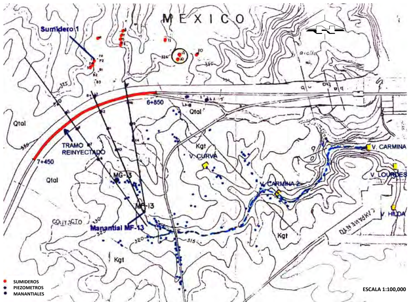
Figura 68. Presa “La Amistad”, plano general de localización de manantiales (Hungsberg, 2001).
