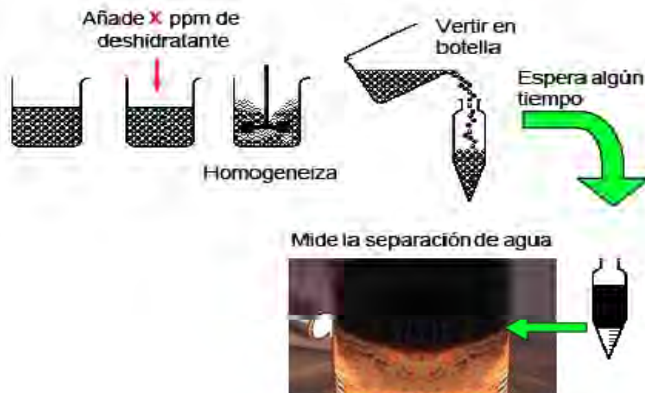
Fig. 4.3. Procedimiento para la realización de la prueba de botella.
