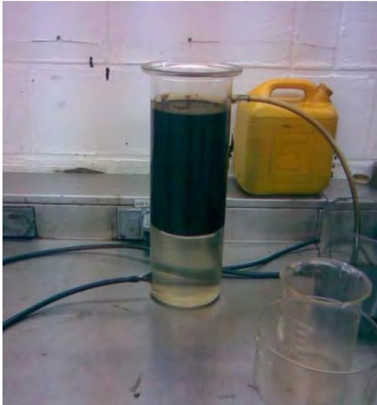
Fig. 5.15. Simulación del proceso de deshidratación en los tanques de lavado.
