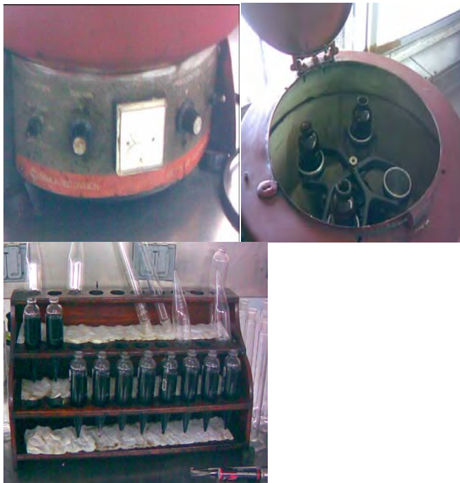
fig.4.1. Equipo centrifugo para medir la cantidad de agua separada del aceite, así como los sedimentos del mismo.
