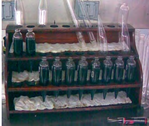
Fig. 1.5. Las muestras se colocan en recipientes graduados para meterse a la centrifugadora y una vez que son separados se miden los porcentajes de agua y sedimentos básicos.
