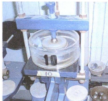
Prueba de Consolidación
