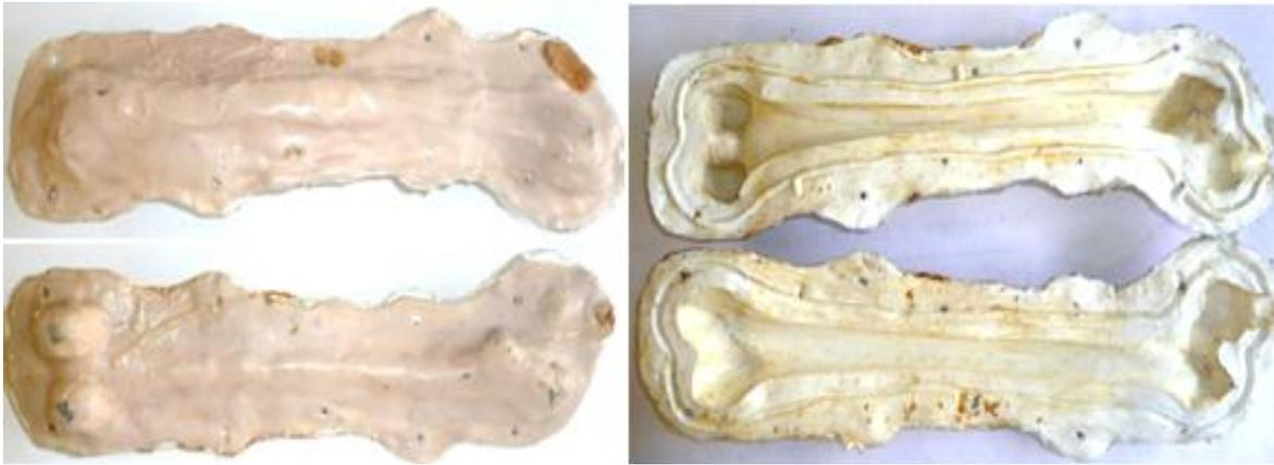
*Figura 2.1 Moldes de silicón para modelos de fémur.*
