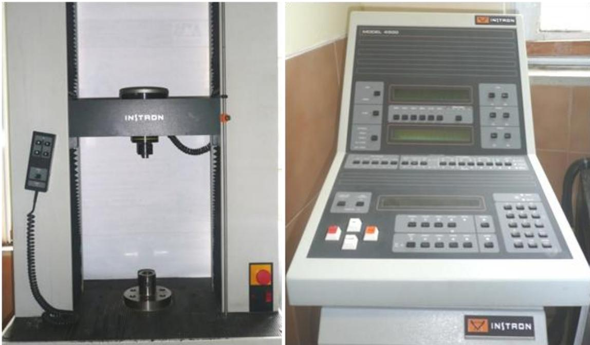
*Figura 3.1 Maquina universal de ensayos INSTRON modelo 4502.*
