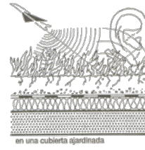
10 Absorción acústica en una capa vegetal blanda
