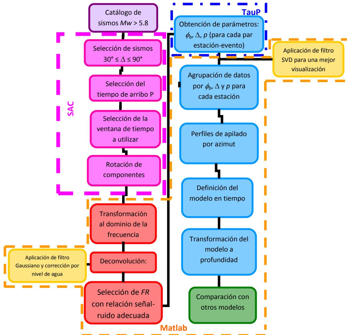
Figura 4.7, ciclo de vida de los datos de banda ancha. Modificado de Espejo & Greene (2006)
