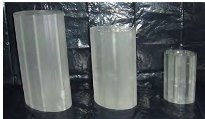
a) b) Figura 5.8.a) Diseño de maniqué representativo de 0 años para tórax. b) Serie de maniqués representativos de tórax.
