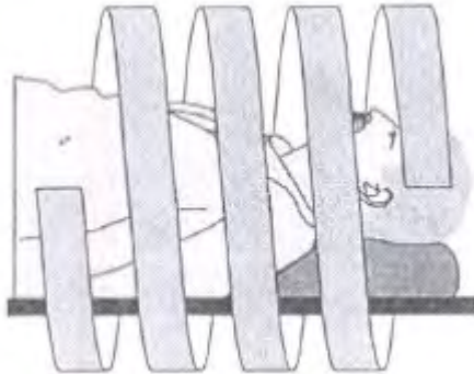
Figura 1.3. Tomógrafo Computarizado de sexta generación (Helicoidales).
