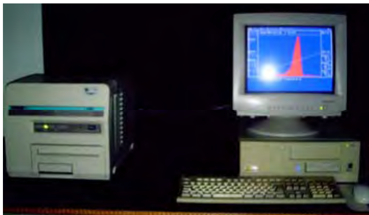
Figura 5.4. Lector termoluminiscente Harshaw 3500 y equipo de computo asociado.
