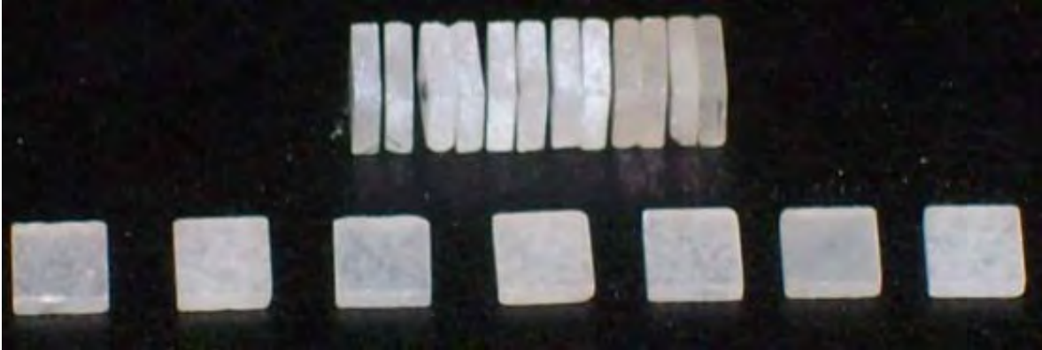
Figura 5.2. Dosímetros termoluminiscentes LiF:Mg,Ti (TLD-100).
