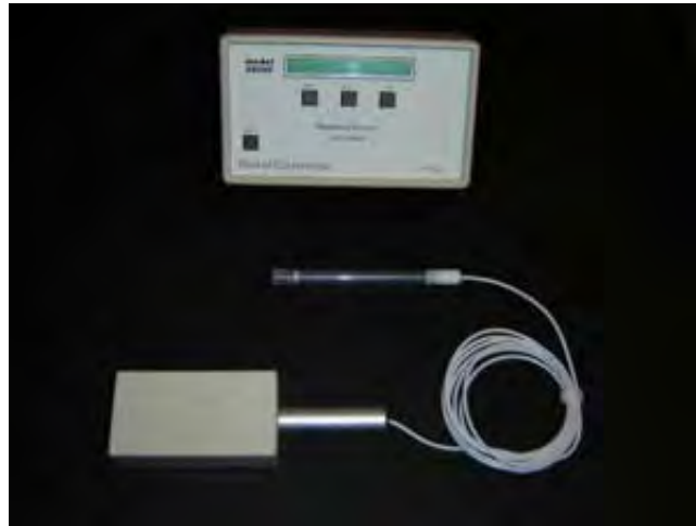
Figura 5.5. Cámara de Ionización con el electrómetro asociado, RADCAL Corporation.
