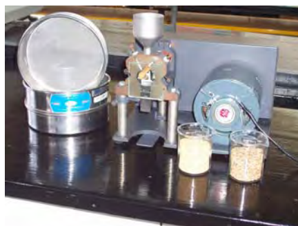
Figura 11. Equipo de molienda y tamices.
