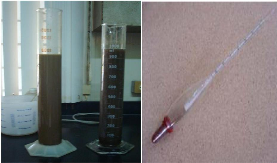
**Figura 8.** Cilindro de sedimentación con sedimento e hidrómetro.
