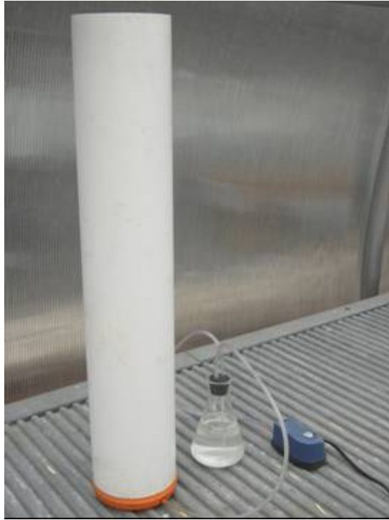
Figura 2. Columna de PVC (Proceso de maduración)
