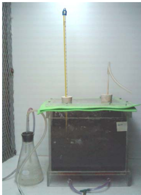
Figura 4. Cámara de compostaje
