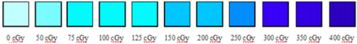
Figura 2.5 Cambio en la coloración de una PTR en función de la dosis.
