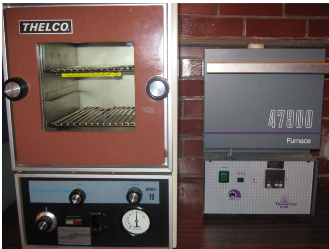
Figura 3.2. Horno y mufla usados para el tratamiento térmico aplicado a los TLD.
