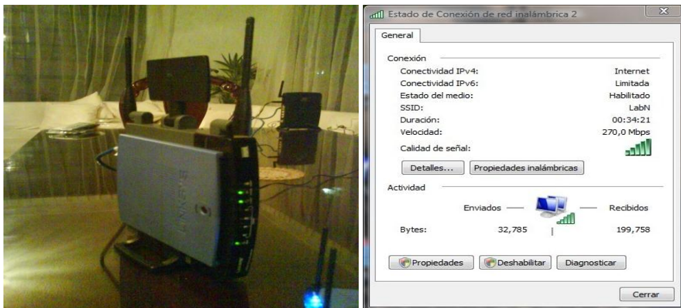
Figura 21.- Posición vertical del AP, posición de sus antenas y tasa de transmisión.
