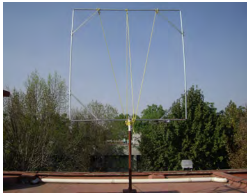
Figura 6.3: Antena de Lazo instalada en el IGEF
