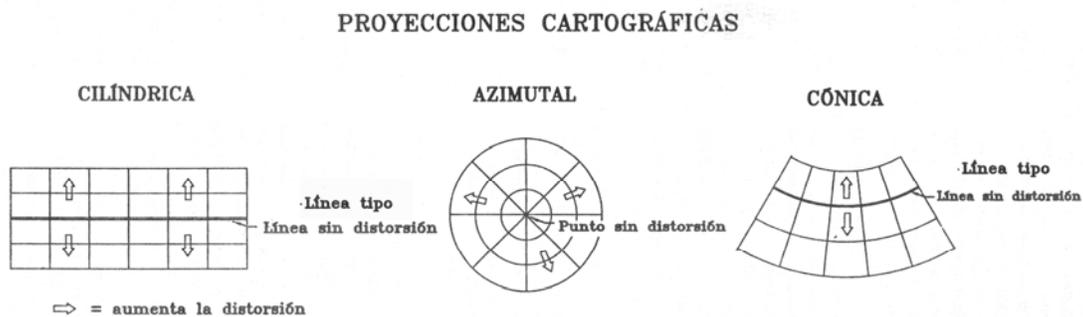
Figura 8. Representación del incremento de la distorsión de las proyecciones cilíndrica, azimutal y cónica, a partir de los puntos o líneas de tangencia. (Modificada de Silva et al., 2006).
