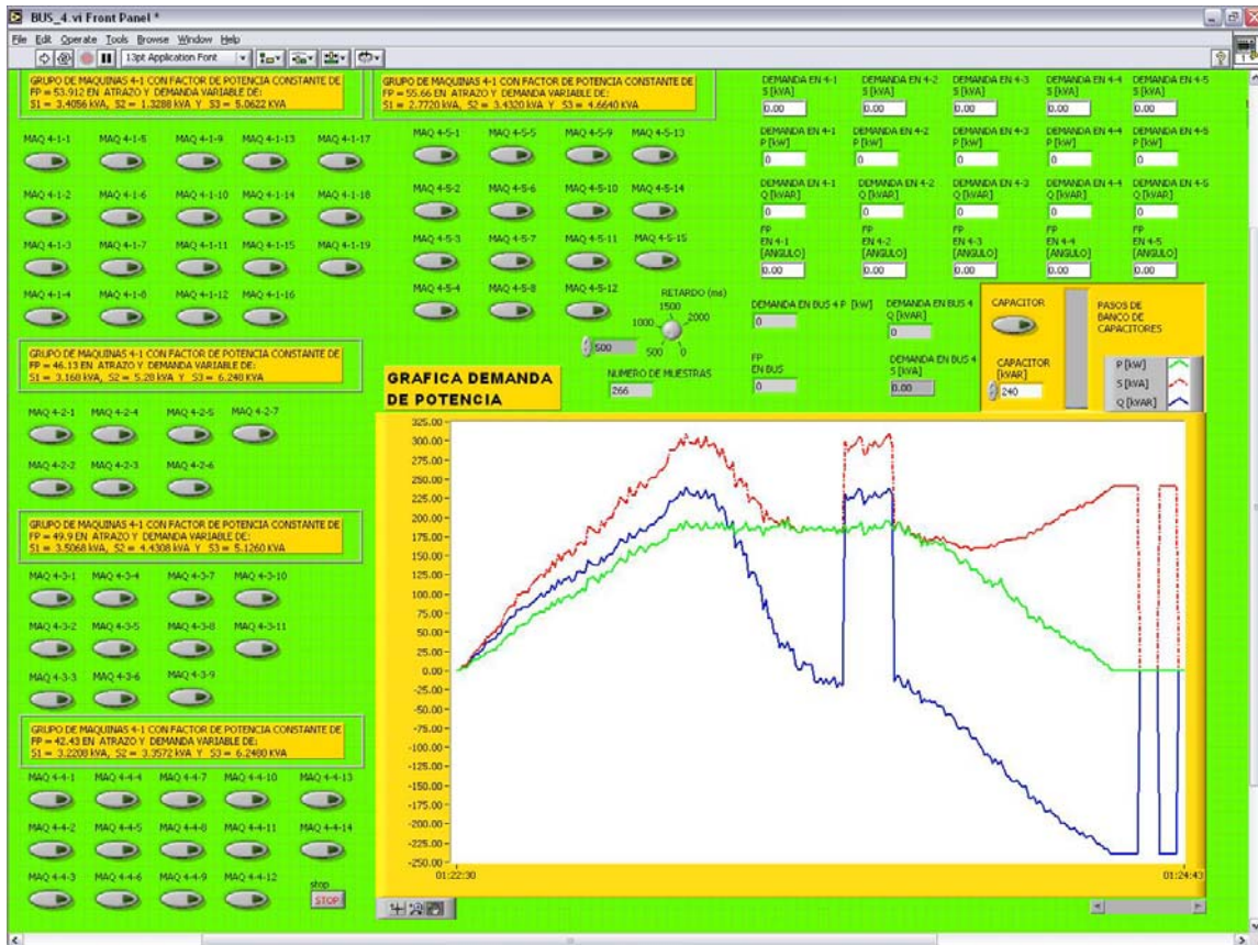
Fig. 28 HMI utilizando LABVIEW para control de producción remota y consumo de energía eléctrica en tiempo real.
