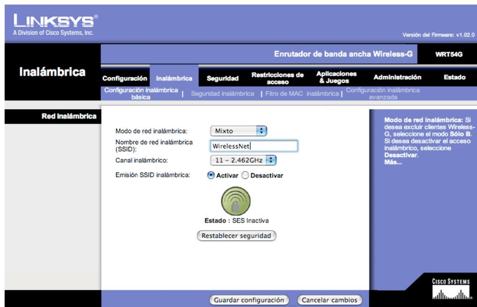
**Fig. 31:** Configuración del SSID.
