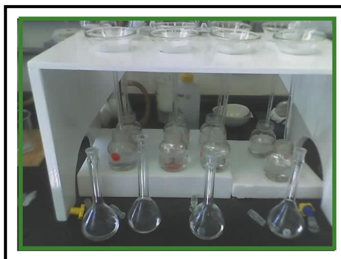
**Figura 2.2 Preparación de la muestra para determinación de fósforo** ( fotos tomadas en CFATA-UNAM Juriquilla, Querétaro)
