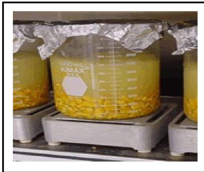
**Figura 1.4. Nixtamalización a nivel laboratorio** (Figueroa, 2004)
