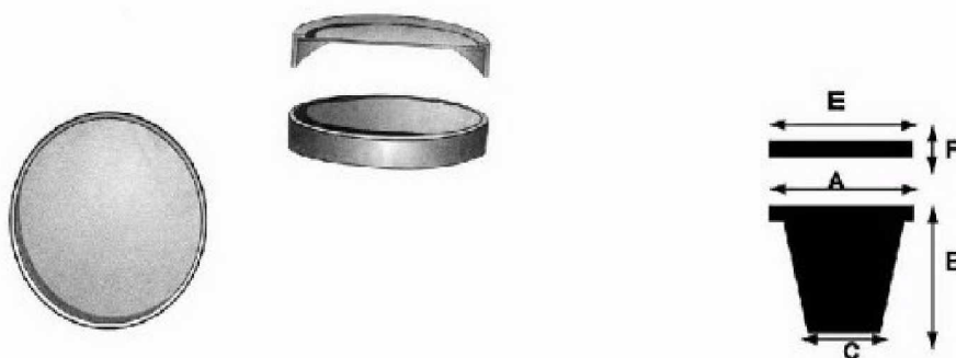
Figura 3.1 Envase de 1 litro de cartoncillo laminado con polietileno.
