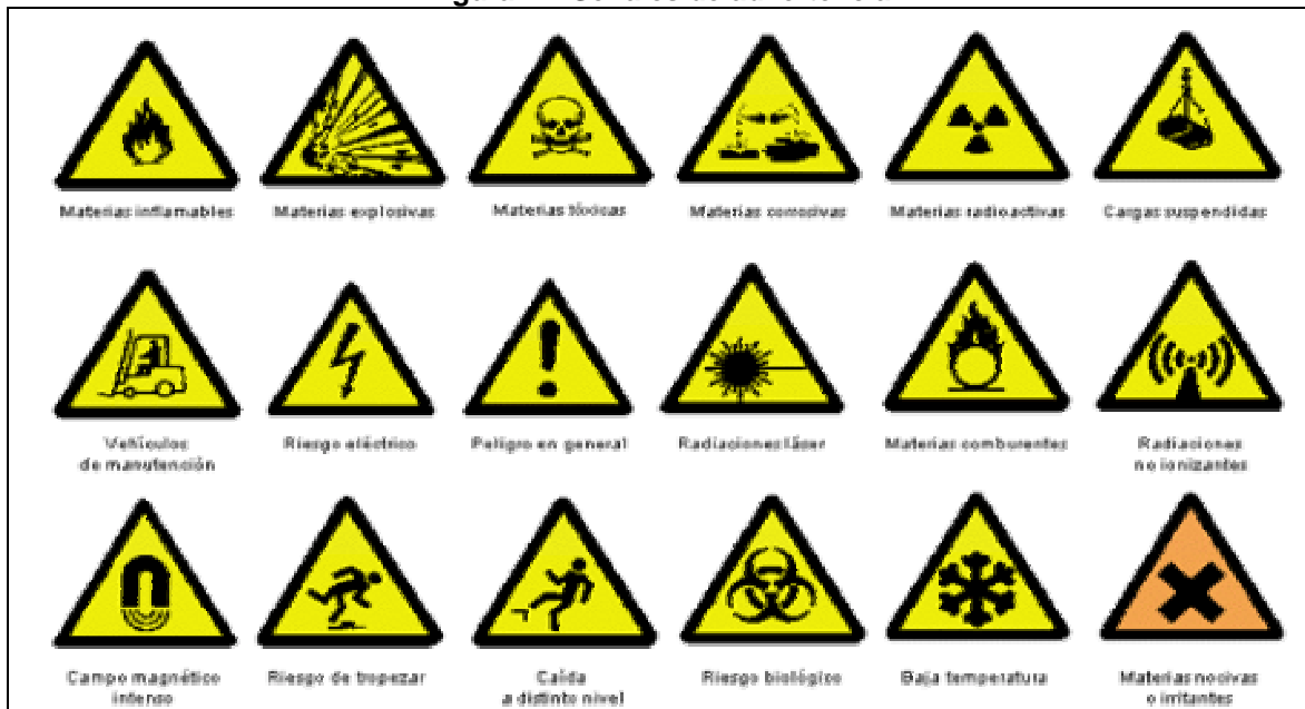
Figura 24. Señales de advertencia
