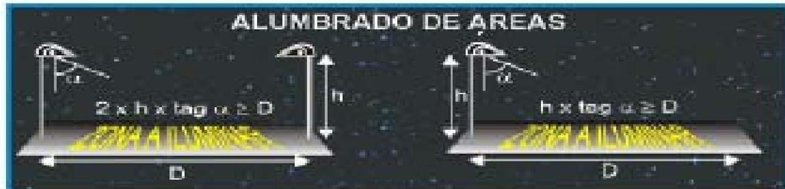
Figura 3.2 Dimensiones para el cálculo de la altura de los soportes para áreas.
