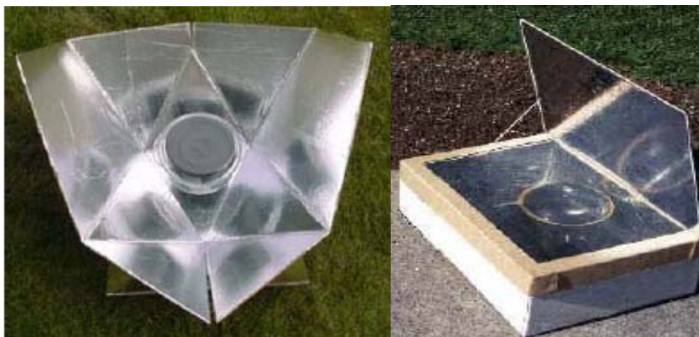
Figura 1.4. Izquierda se muestra un horno de paneles, a la derecha un horno de acumulación. Obtenidas de http://www.cie.unam.mx/~ojs/pub/Presentaciones/Cocinando_SOL.pdf
