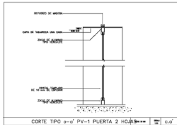
CORTE TIPO g-a' PV-1 PUERTA 2 HOJAS DT-3
