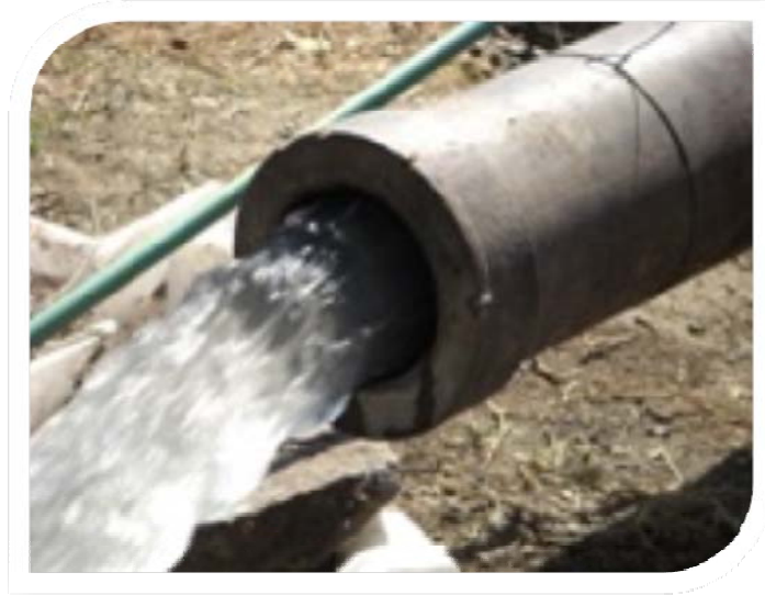
Figura 38.- Tubo de ademe reducido de 8" a 6" para medir el gasto
