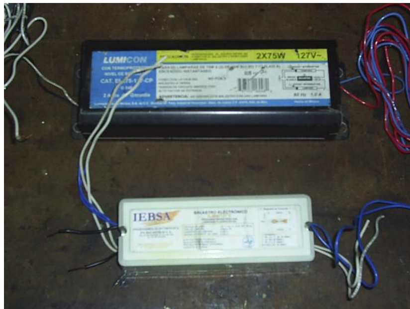
DIFERENCIA DE TAMAÑO DE UN BALASTRO ELECTROMAGNÉTICO A UN ELECTRÓNICO
