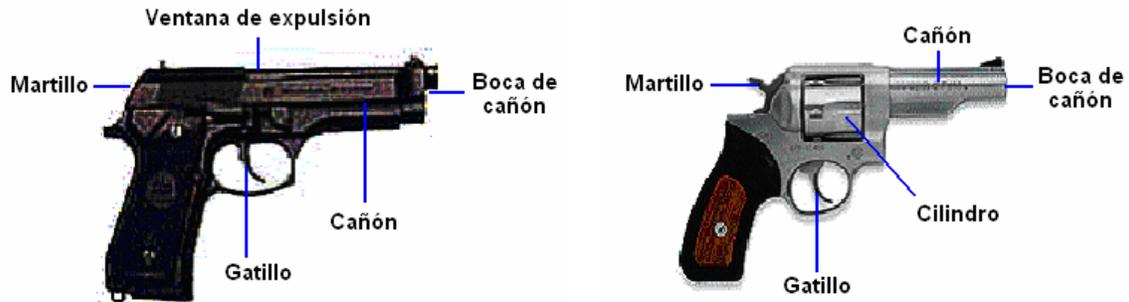
Figura 1. Partes de armas de fuego cortas: escuadra (izq.) y revólver (der.) [1].
