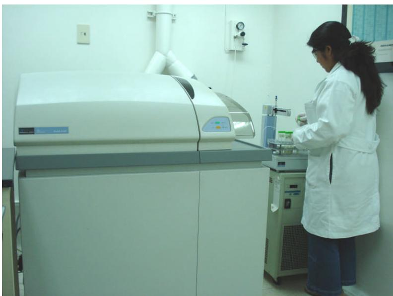
Fig. 30. Análisis de las muestras en el ICP-MS Elan 6100 [25].
