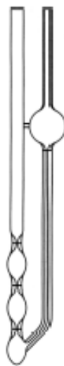
Figura 5.4. Viscosímetro capilar tipo Cannon-Fenske usado para la determinación de viscosidad del biodiesel.
