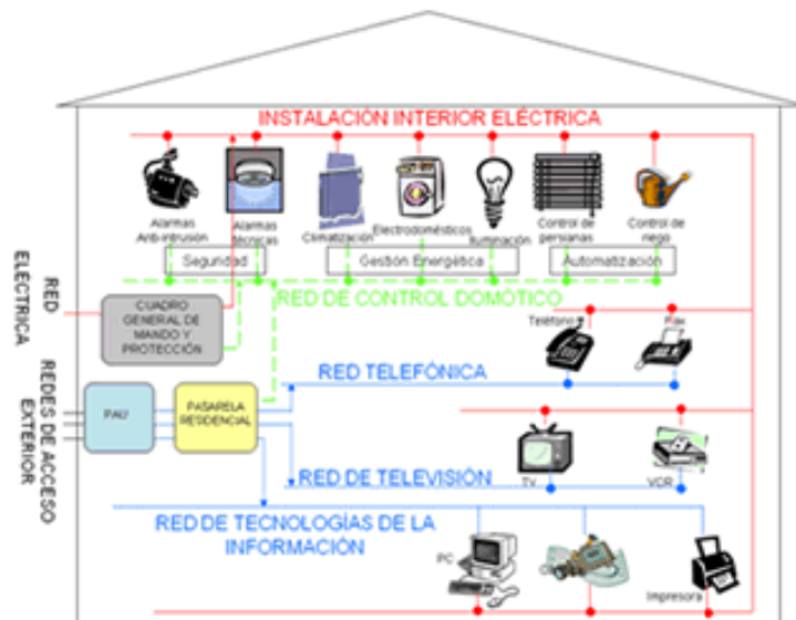
Figura 1 . 3 Diagrama de dispositivos y tipos de redes que pueden ser controlados en una instalación domótica
