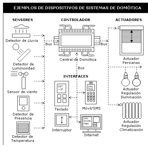
Figura 1 . 1 Ejemplos de dispositivos que pueden ser controlados en una vivienda u oficina
