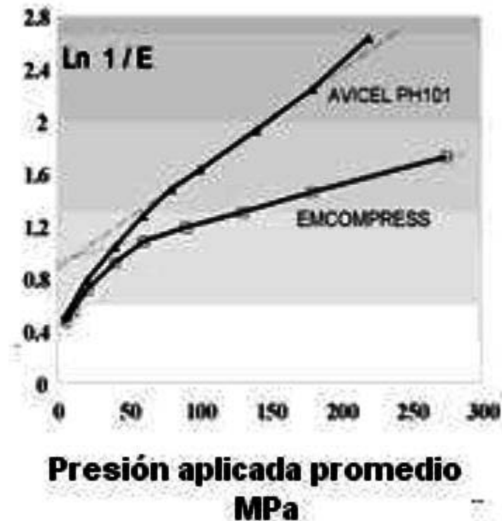
Figura. 20 Ejemplos de la ecuación de Heckel.
