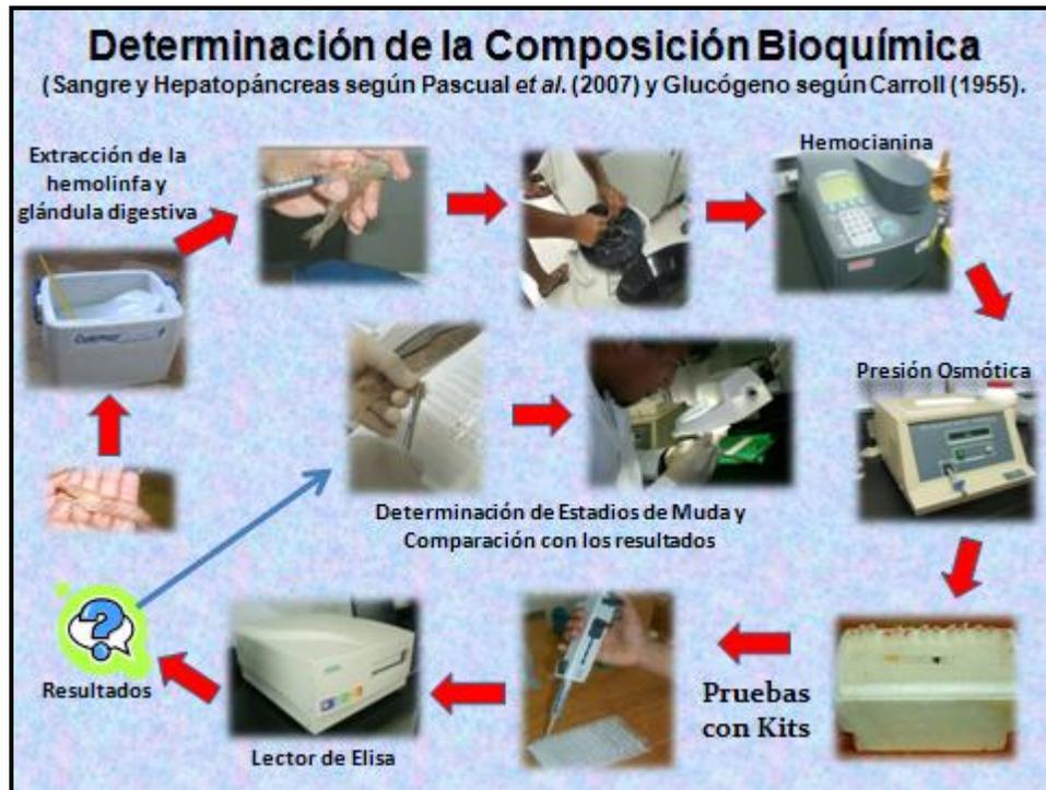
Fig. 5. Diagrama de procedimiento en laboratorio de la extracción y lectura en sangre y glándula digestiva, para determinar la composición bioquímica y su relación con los estadios de muda. (Nótese algunos de los instrumentos y equipos utilizados para las lecturas)
