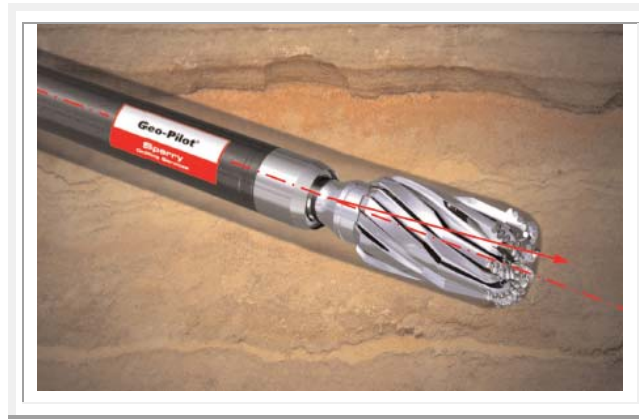
Figura III.49. El sistema Geo-Pilot ® , se basa en el concepto de doblar un eje de transmisión fuera del centro para ocasionar la inclinación, apuntando así la barrena a la dirección deseada (Halliburton, 2007).
