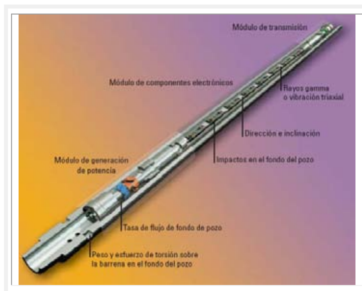
Figura III.6. Componentes de fondo de pozo del servicio TeleScope® (Schlumberger, 2006).
