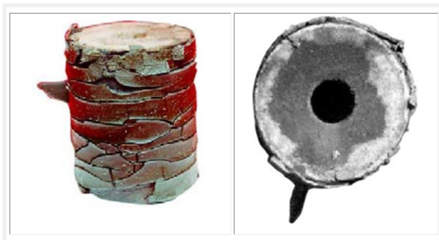
Figura 3.20. a) Enjarre con tratamiento de WBR. b) corte radial de núcleo tratado con WBR , (Swatman et al. , 1999).
