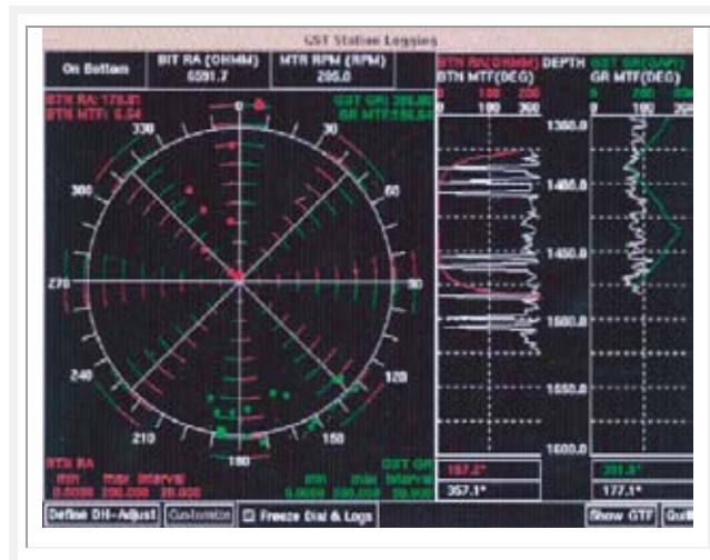
Figura II.1.53. Estación de datos para la geonavegación. En rojo los datos de resistividad; en verde los rayos gamma (Bonner et al., 1993a).
