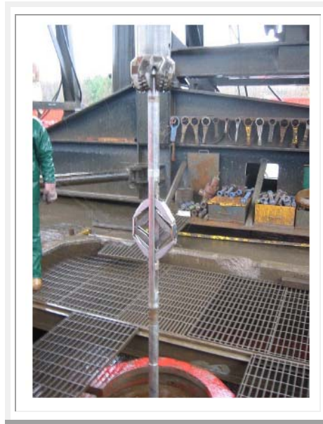
Figura II.3.25. Probador de presión de formación (MFT) y la barrena TBL de 8½ in ( Runia et al., 2004 ).
