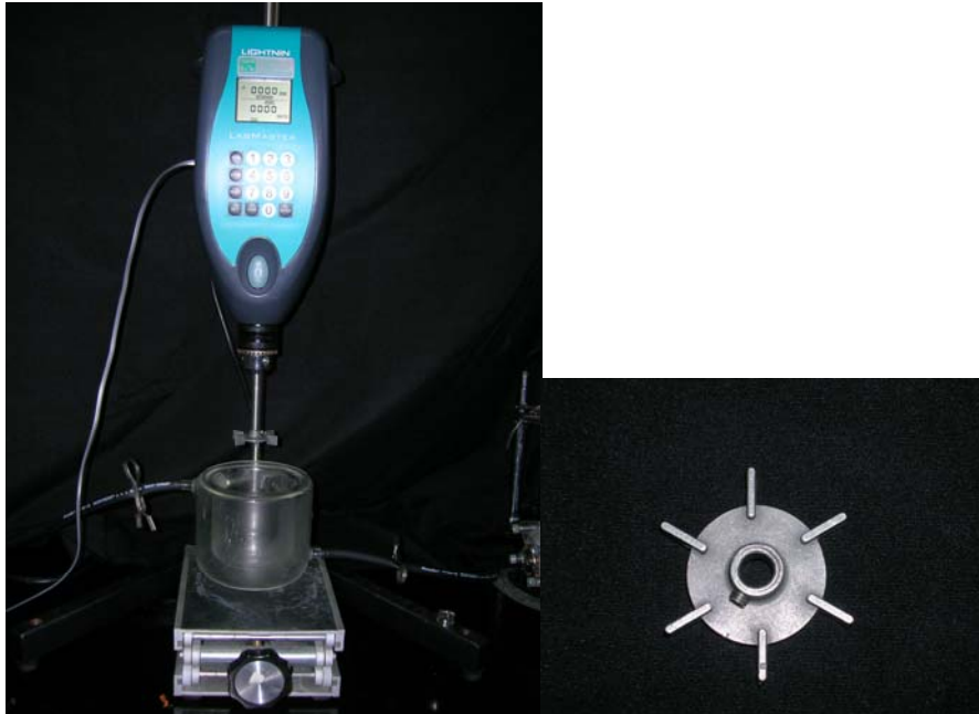
Figura 3.5. Equipo de agitación para formación de emulsiones y propela de aspas planas.
