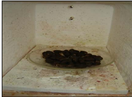
Figura 3.5. Secado de semilla de Jatropha curcas por medio de la estufa (45 °C) durante 2 h.
