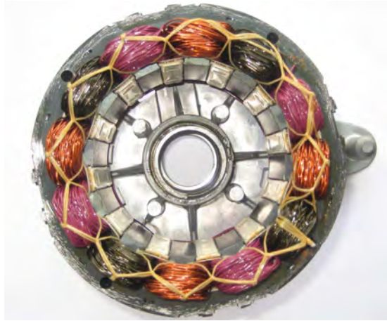
Figura 4.1: Vista frontal de estator donde se observan los 12 polos
