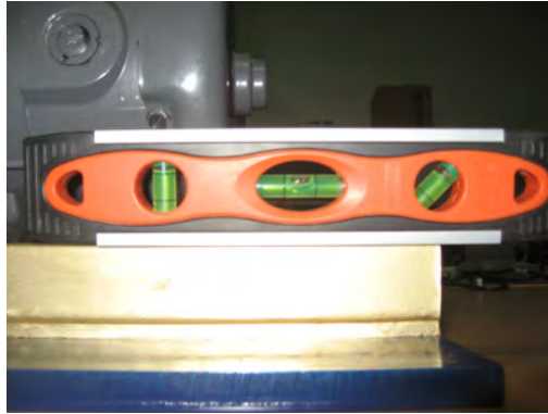
Figura 4.7: Alineación de los rieles metálicos
