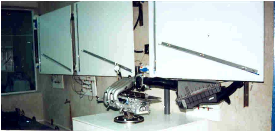
Fotografía 2.2.2. Montaje del colector de admisión (aluminio), la caja de mariposa, conducto intermedio, portafiltro, filtro y el conducto final a la culata del motor 2L.
