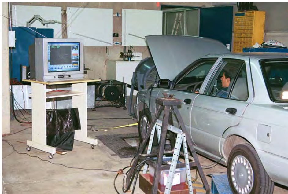
Fotografía 2.1.1. Instrumentación del vehículo y seguimiento de un ciclo de manejo.
