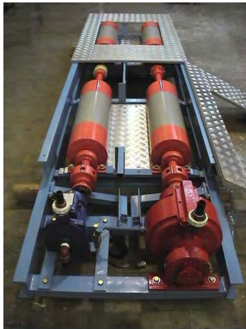
Figura 3.2. Dinamómetro de chasis: Dinamotor (4 rodillos, freno hidráulico) .
