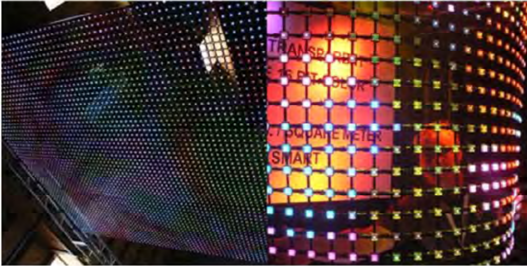
Figura 4.11: Coolgrid es una pantalla flexible y modular de LEDs, utilizada generalmente para diseños arquitectónicos.
