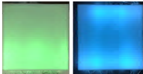
Figura 4.41: Pruebas para determinar la cantidad de LEDs necesarios para iluminar el área de un píxel y cuánto brillo se genera. La imagen de la izquierda muestra un píxel con tres LEDs, mientras que la de la derecha muestra otro píxel con cuatro LEDs.
