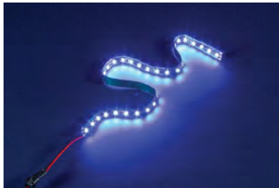
Figura 4.53: Tiras flexibles de LEDs RGB
