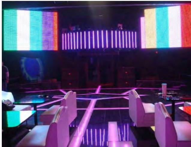
Figura 4.48: Las pantallas de LEDs generan mayor brillo, al utilizarlas como televisores, que los proyectores regulares.
