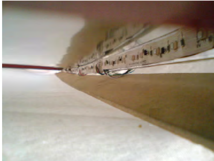
Figura 4.36: Detalle de LEDs entre el material reflejante y el material difusor.
