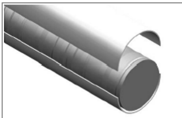
Figura 31. Acoplamiento de cunas para proteger el núcleo.
