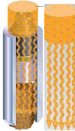
Figura 16. Activación del pistón que libera el líquido
