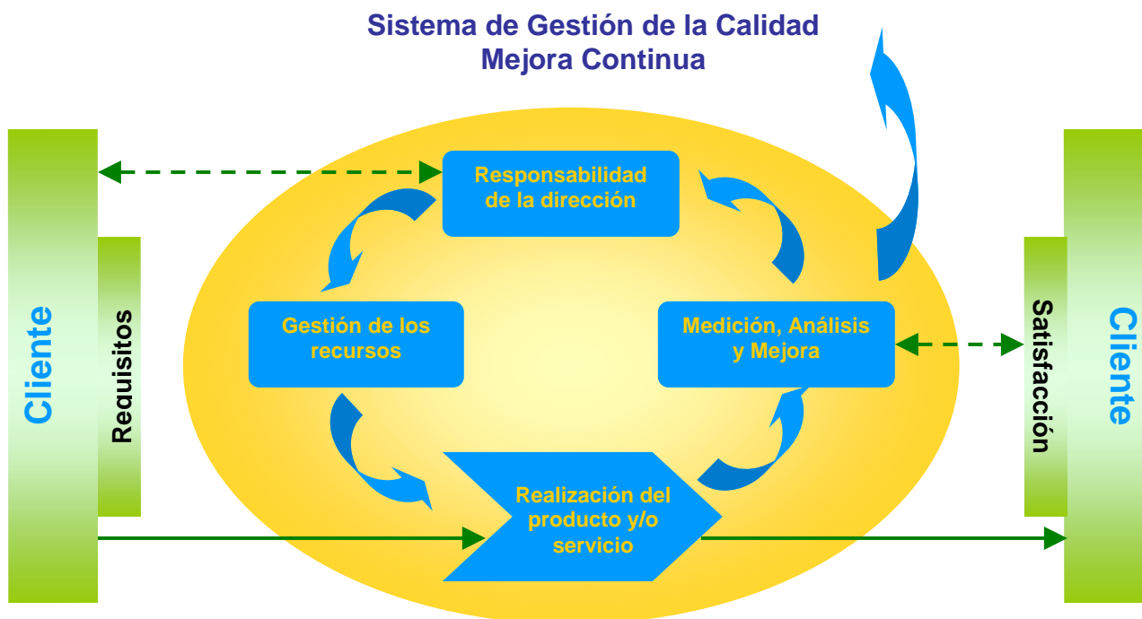
Figura 14. Modelo de un sistema de gestión de la calidad basado en procesos (NMX-CC-9001-IMNC-2000, pp. 3).
