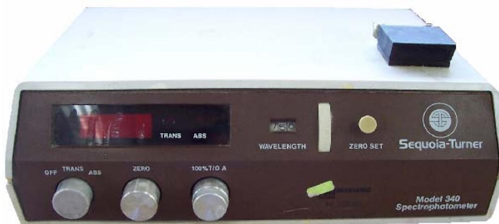
**Figura 10.** Espectrófotometro para azúcares y ácidos galacturonicos
