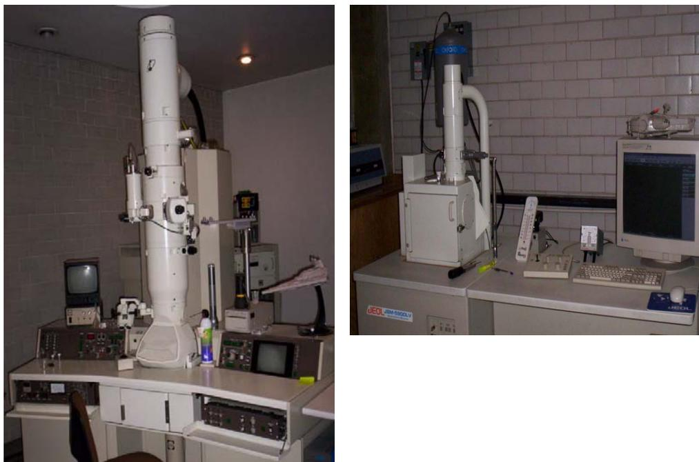
Figura 2.4.3. De izquierda a derecha, microscopio electrónico de transmisión (TEM) y microscopio electrónico de barrido (SEM).
