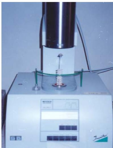
Figura 2.4.2. Termobalanza del equipo de análisis termogravimétrico
