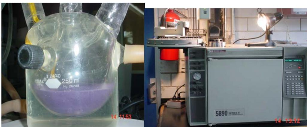
Figura 2.4.4. A la izquierda se observa el reactor de tres bocas para las pruebas catalíticas y a la derecha el cromatógrafo de gases.
