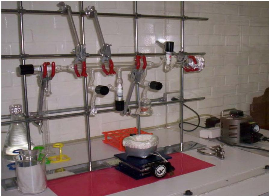
Figura 2.1.1. Equipo utilizado para la funcionalización de nanotubos de carbono
