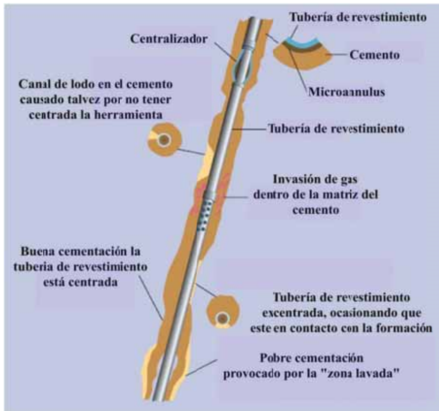
Figura 40. Problemas de desplazamiento de la mezcla de cemento, Tomado de Cement Slurry, Brochure of Schlumberger, 2004
