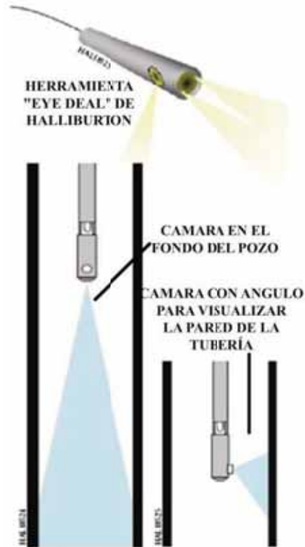
Figura 37. Esquema que ilustra la adquisición de video dentro de un pozo. Algunas herramientas como esta (Eye Deal™ de Halliburton) tienen dos cámaras, una en la “punta” de la herramienta para observar el pozo a lo largo de su trayectoria y la otra a un costado que toma a detalle la video sobre la tubería de revestimiento, inspeccionando algunos daños. Modificado de “Wireline and Perforating Services Down-Hole Camera Services”, Halliburton, 2004”
