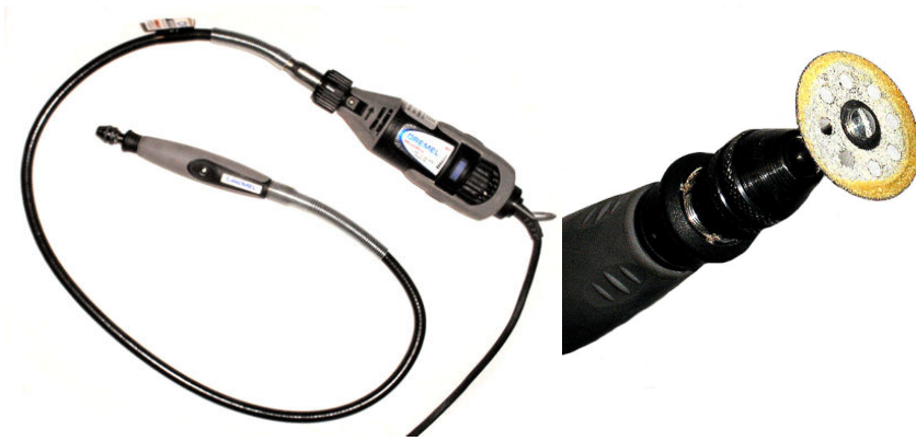
Figura 2.2. Herramienta rotatoria de alta velocidad (Dremel) con el disco diamantado para realizar el corte.
