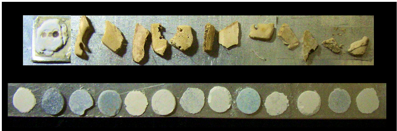
Figura 2.8. En la parte superior se observan los fragmentos de hueso con las superficies (periostio, endostio y centro) listas para ser irradiadas. En la parte inferior se presentan las pastillas que se hicieron con el polvo resultante de la limpieza química de las muestras óseas.
